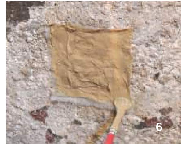
**Prove di rimozione con soluzioni acquose:** tampone in ovatta, polpa di cellulosa, sepiolite, carta giapponese imbibite di acqua deionizzata
