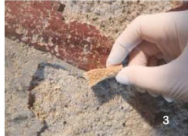
**Prove di rimozione a secco:** 1 - gomma siliconica, 2 - spugna in lattice sintetico, 3 - spugna in silicone vulcanizzata
